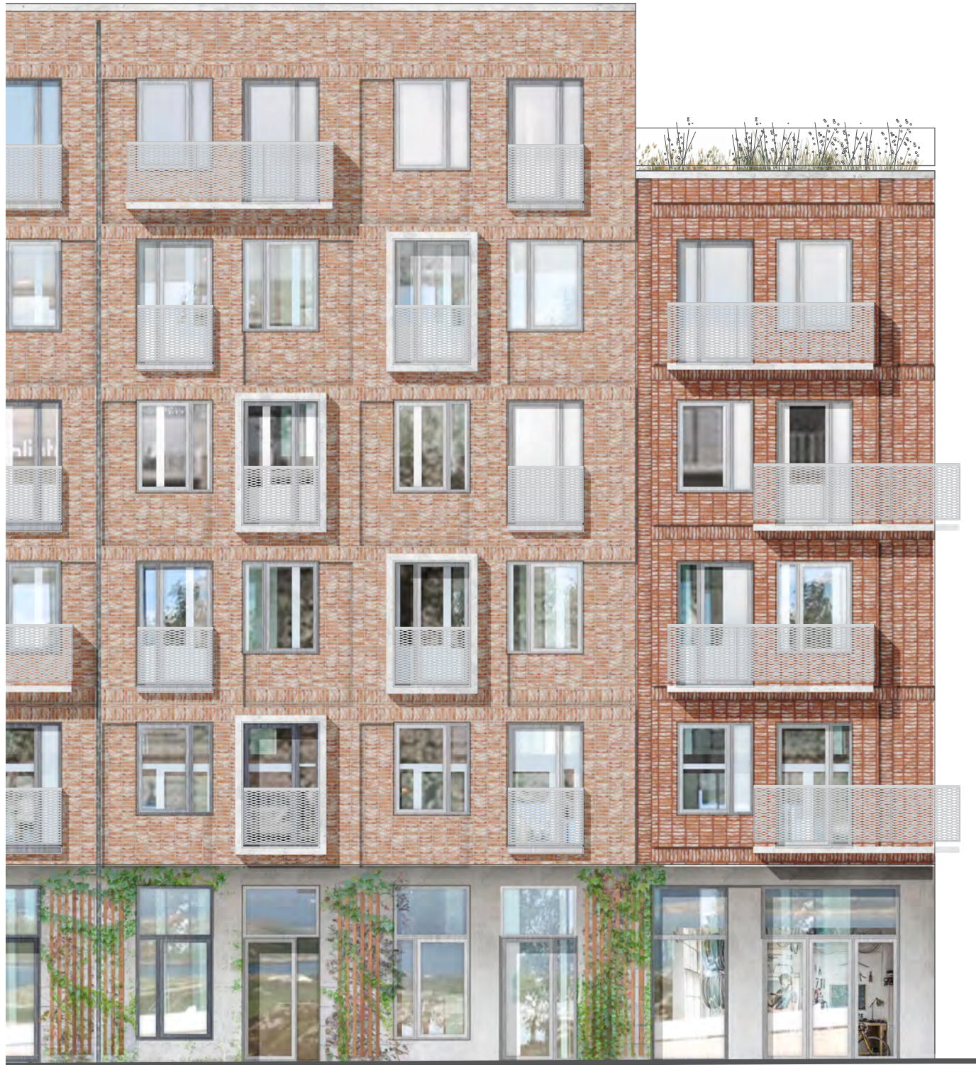
Facade etagebyggeri - tilbagerykkede felter, lodret/vandret markering
